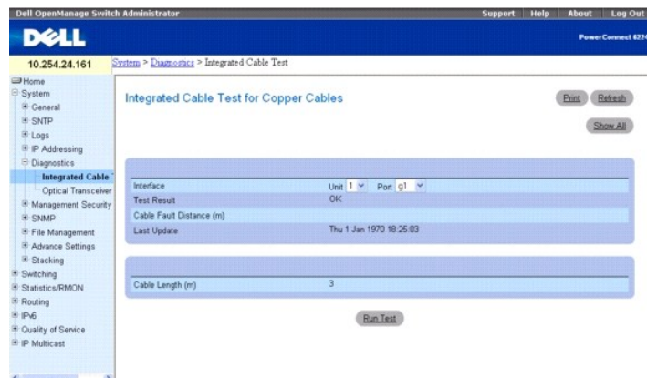
Abbildung 6-32. Integrierter Kabeltest für Kupferkabel
